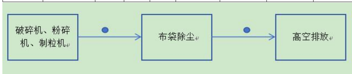
图 3-1 废气处理流程 (● 监测点位)
